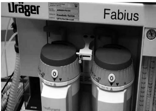
Рисунок 1. Переключатель-блокиратор расположен между испарителями
